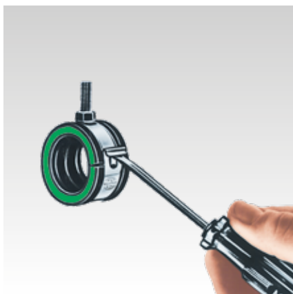
Fermeture : pousser avec un tournevis sur l'oreille du collier vers l'intérieur
